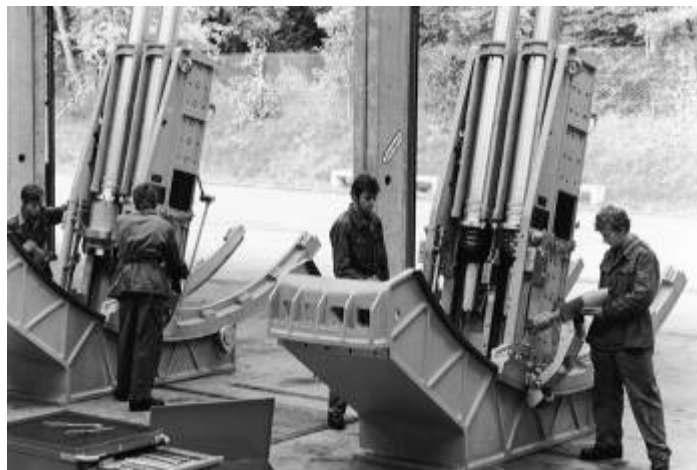
Vormontage und Funktionskontrolle von zwei 12 cm Festungs-Mw 59 in der Eidgenössischen Waffenfabrik Bern Premontaggio e controllo del funzionamento di due lanciamine da fortezza da 12 cm 59 presso la Fabbrica federale di armi di Berna
