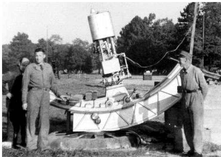
Versuchsschiessanlage 12 cm Mehrfachminenwerfer SIG am 20.9.1956 in Thun Impianto per i tiri di prova del lanciamine multiplo 12 cm SIG (Thun, 20.9.1956)
