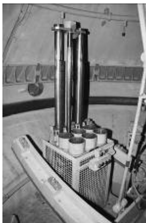
Geschützraum 12 cm Fest Mw 59 Foppa Grande SIG-Munitionslift für 6 Geschosse Vano del pezzo del lm fort 12 cm 59 Foppa Grande Ascensore SIG delle munizioni per 6 colpi
