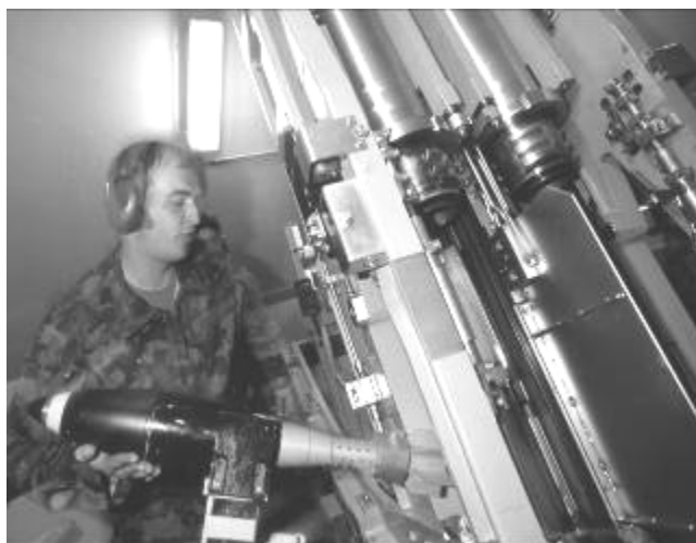
Geschützraum: 12 cm Mw-Rohre unverriegelt offen mit Ladevorrichtung
