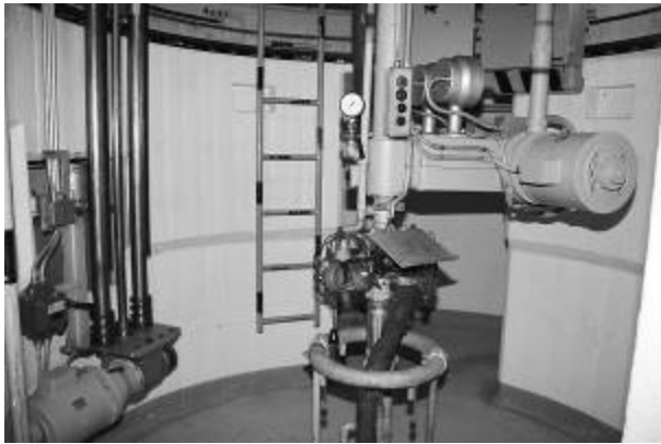
Richtraum 12 cm Fest Mw 59 Foppa Grande mit Richtantrieb der ersten Generation: Munitionslift, Aufstiegsleiter, Steuerung und Energiezufuhr
